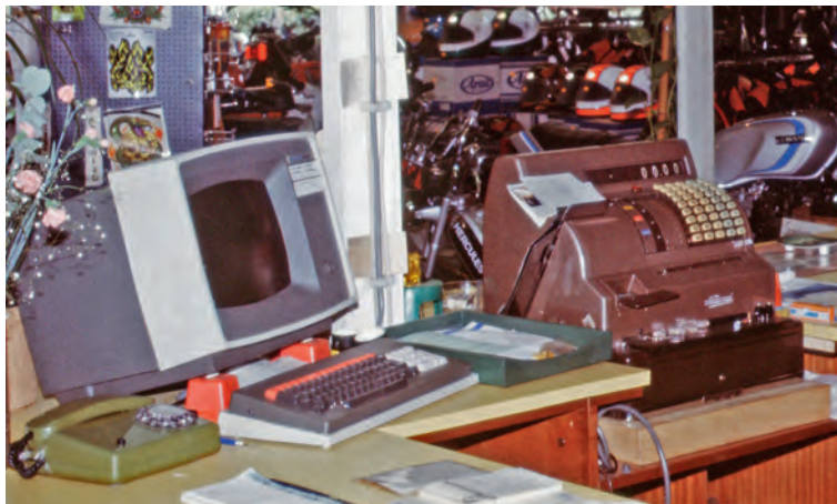
Kundenfoto ca. 1980 Zweiradcenter Müller Gummersbach links BC7-VELODATA-ZLBS-Warenwirtschaft+Kassenplatz nicht mehr zulässig. rechts mechanische alte Registrierkasse auch 2022 noch zulässig
