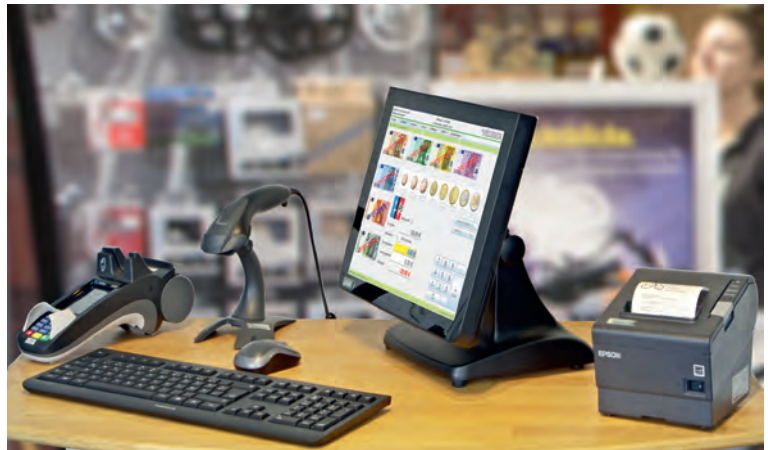
VELODATA vKASSE 4.0 seit 2016 Bei dem abgebildeten Kassenplatz handelt es sich um eine kompakte Einheit aus Touchmonitor und Rechner.
